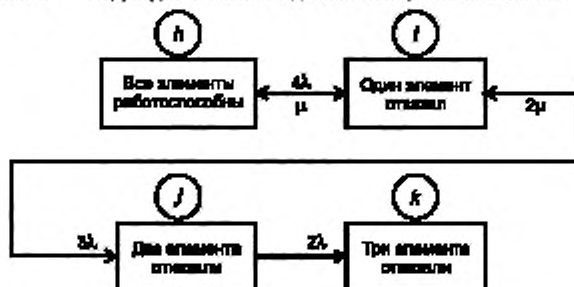
Рисунок 13 — Структурная схема надежности параллельной системы 2/4
