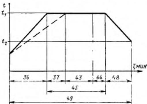
$t_1$ —температура стерилизации, °С;  $t_2$ —температура охлаждения, °С; —— изменения температуры в точках наименьшего трулодоступных для стерилизующего агента
