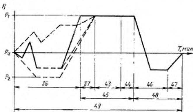
$P_a$  — атмосферное давление, Па;  $P_f$  — давление пара при температуре стерилизации, Па;  $P_v$  — вакуум по заданной программе, Па; — — — изменение давления в точках полезного объема наиболее труднодоступных для стерилизующего агента
