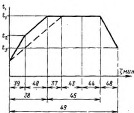
$t_1$  — температура стерилизации, °C;  $t_2$  — точка кипения воды при атмосферном давлении, °C;  $t_3$  — температура охлаждения, °C; — — — изменение температуры в точках полезного объема канбоке более труднодоступных для стерилизующего агента
