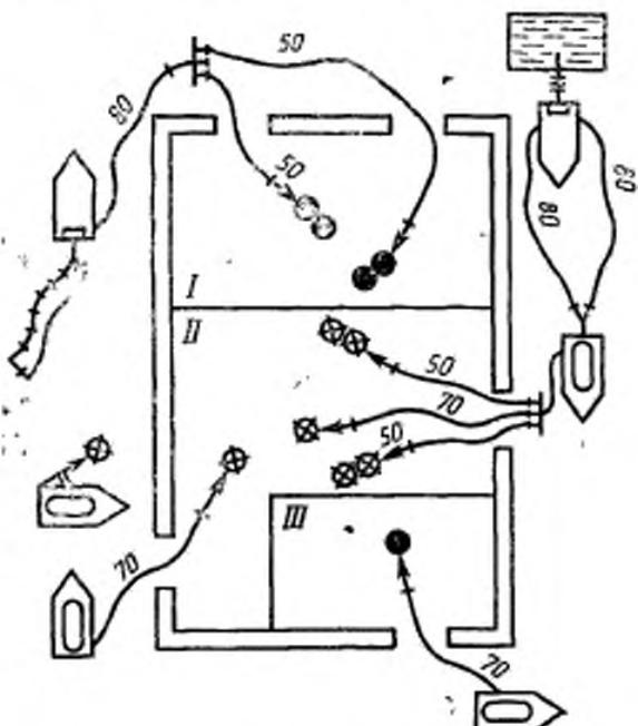
I — тушение пеной средней кратности, подаваемой двумя ручными пожарными стволами; II — тушение распыленной струей, подаваемой двумя ручными пожарными стволами  $D_y = 50$  мм и компактной струей, подаваемой двумя ручными пожарными стволами  $D_y = 70$  мм; III — тушение пеной низкой кратности, подаваемой ручным пожарным стволовом
