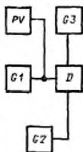
*PV* — измеритель постоянного напряжения; *G1* — генератор постоянного тока; *G2*, *G3* — источники постоянного напряжения; *D* — микросхема
