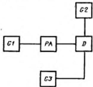
$G1, G2, G3$  — источники постоянного напряжения;  $PA$  — измеритель постоянного тока;  $D$  — микросхема
