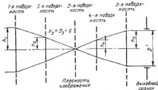
Диаметр рабочего отверстия  $n$ -й поверхности оптической системы  $D_n$  вычисляют по одной из следующих формул:
