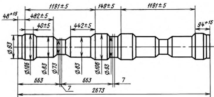
3. Предельные отклонения диаметров не должны превышать  $+1,0$   $-1,5$  мм.
