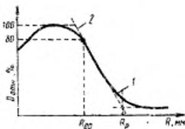
$D_{rel}$  — относительная поглощенная доза или относительный ионизационный ток;  $R$  — глубина в водном фантоме; 1 — кривая осевой относительной глубинной дозы или ионизации; 2 — касательная в точке перегиба.
