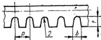
t — высота сечения между зубьями; b — ширина паза; p — шаг зуба
