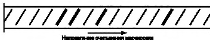
Рисунок 2 — Пример прокатной маркировки предприятия-изготовителя под номером 14
