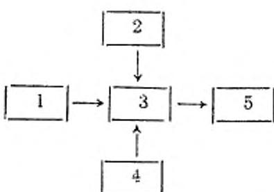
1—источник света с ослабителями светового потока, источником питания и вольтметром контроля режима работы; 2—вольтметр измерения напряжения запирания; 3—светонепроницаемая камера с фотоумножителем; 4—источник питания фотоумножителя с делителем напряжения (или отдельные источники питания электродов) с вольтметром контроля режима работы; 5—амперметр
