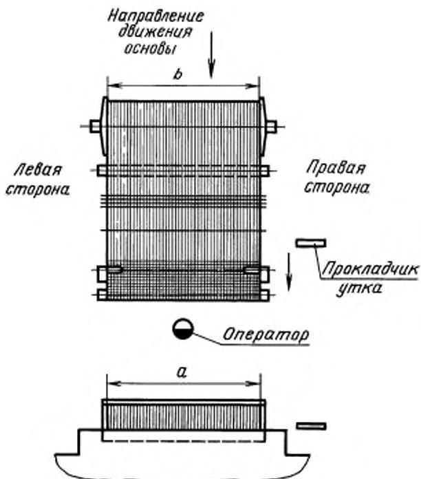
*a* — рабочая ширина, максимально возможная ширина проборки основы по берду, включая кромки; *b* — максимальная ширина основы; расстояние между внутренними поверхностями фланцев ткацкого ная
