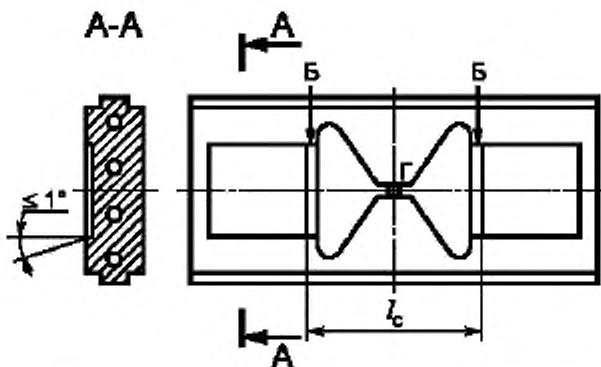
Г — центральный литник с диаметром со стороны сопла не менее 4 мм;
