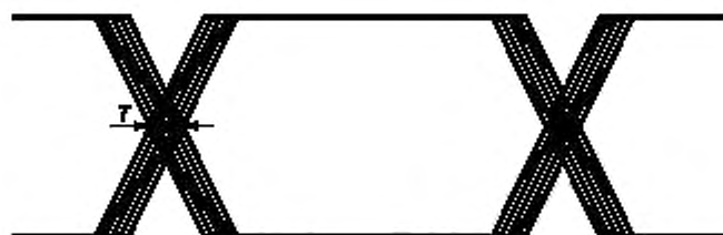
Рисунок 8 — Диаграмма, поясняющая измерение фазового дрожания цифрового сигнала
