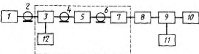
1—измерительный генератор; 2, 4, 6—коаксиальный кабель; 3—коаксиальный переключатель; 5—фильтр; 7—согласующее устройство; 8—коаксиальный соединитель; 9—образцовый делитель напряжения; 10—проверяемый вольтметр; 11—образцовый вольтметр; 12—нагрузочный резистор
