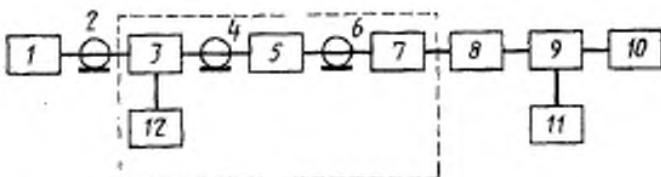
1—измерительный генератор; 2, 4, 6—коаксиальный кабель; 3—коаксиальный переключатель; 5—фильтр; 7—согласующее устройство; 8—коаксиальный соединитель; 9—коаксиальный измерительный соединитель-транзистор (например элемент № 11—1 из комплекта вольтметра типа В3-24); 10—проверяемый вольтметр; 11—образцовый вольтметр; 12—нагрузочный резистор
