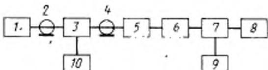
1—измерительный генератор; 2, 4—коаксиальный кабель; 3—коаксиальный переключатель; 5—фильтр; 6—коаксиальный соединитель; 7—образцовый делитель напряжения; 8— поверяемый вольтметр; 9—образцовый вольтметр; 10—нагрузочный резистор
