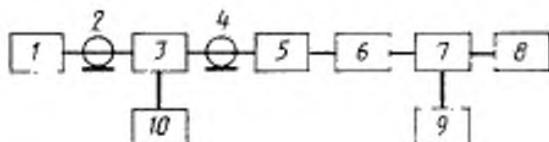
1—измерительный генератор; 2, 4—коаксиальный кабель; 3—коаксиальный переключатель; 5—фильтр; 6—коаксиальный соединитель; 7—коаксиальный измерительный соединитель-тройник (например элемент № 11 из комплекса вольтметра типа В3—24); 8— поверяемый вольтметр; 9—образцовый вольтметр; 10—нагрузочный резистор
