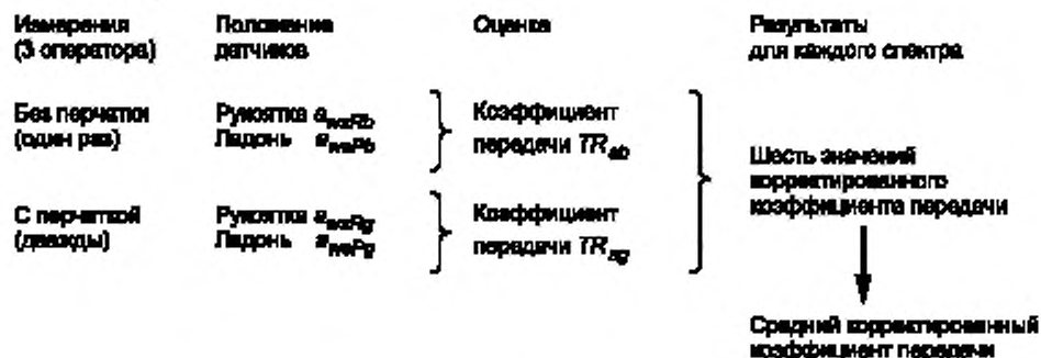
Рисунок 7 — Схема определения среднего скорректированного коэффициента передачи
