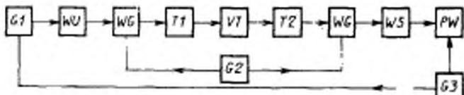
$G1$  — источник сигнала;  $WU$  — развязка;  $WG$  — вход питания при подаче питания через контактное устройство может отсутствовать;  $T1$  и  $T2$  — входной и выходной трансформаторы полных сопротивлений;  $VT$  — измеряемый транзистор с контактным устройством;  $WS$  — вентиль в ряде случаев может отсутствовать;  $PW$  — измеритель шумовой мощности и индикатор;  $G2$  — блок питания транзистора по постоянному току;  $G3$  — блок питания и управления измерителем
