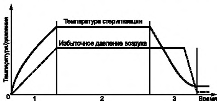
Рисунок В.3 — Пример цикла стерилизации паровоздушной смесью
