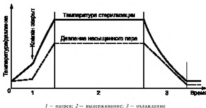
Рисунок В.1 — Пример цикла стерилизации с использованием насыщенного пара и проветривания
