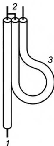
1 — несимметричный вход; 2 — симметричный выход; 3 — полуволновая петля
