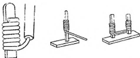
Электрические соединения с фиксацией провода на контактном штыре по методу накрутки
