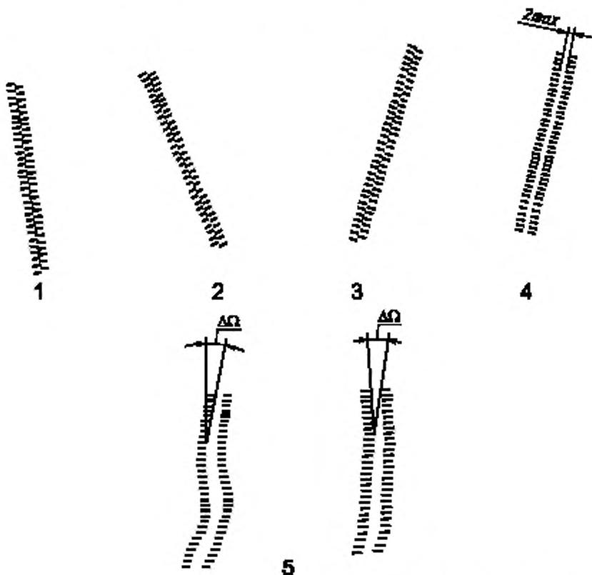
1, 2, 3 — отсутствие дефектов; 4 — импульсный камень смещен с линии центров «вилка — баланс» при нахождении системы «баланс — спираль» в положении статического равновесия; 5 — система «баланс — спираль» неизохронна, периодически меняется амплитуда колебаний баланса;  $\Delta\Omega$  — изменение суточного хода
