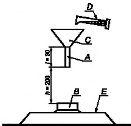
А — трубка воронки длиной  $l = 30$  мм внутренним диаметром 8 мм; В — прибор для испытания; С — воронка; D — сосуд с 30 мл соляного раствора; Е — горизонтальная поверхность;  $h$  — высота расположения нижнего конца трубы воронки относительно прибора
