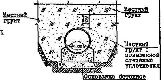
УКЛАДКА АСБЕСТОЦЕМЕНТНЫХ И КЕРАМИЧЕСКИХ ТРУБ НА ЖЕЛЕЗОБЕТОННОЕ ОСНОВАНИЕ
