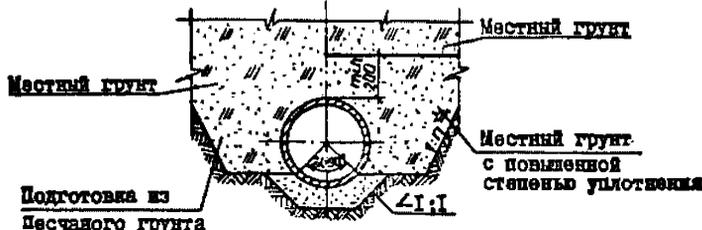
УКЛАДКА АСБЕСТОЦЕМЕНТНЫХ, КЕРАМИЧЕСКИХ, ПЛАСТМАССОВЫХ И ЧУГУННЫХ ТРУБ НА ГРАВИЙНО-ЩЕБЕНОЧНУЮ ПОДГОТОВКУ
