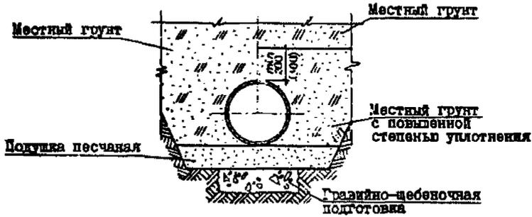
УКЛАДКА АСБЕСТОЦЕМЕНТНЫХ, КЕРАМИЧЕСКИХ И ЧУГУННЫХ ТРУБ НА БЕТОННОЕ ОСНОВАНИЕ С ОХВАТОМ ТРУБЫ НА 90°
