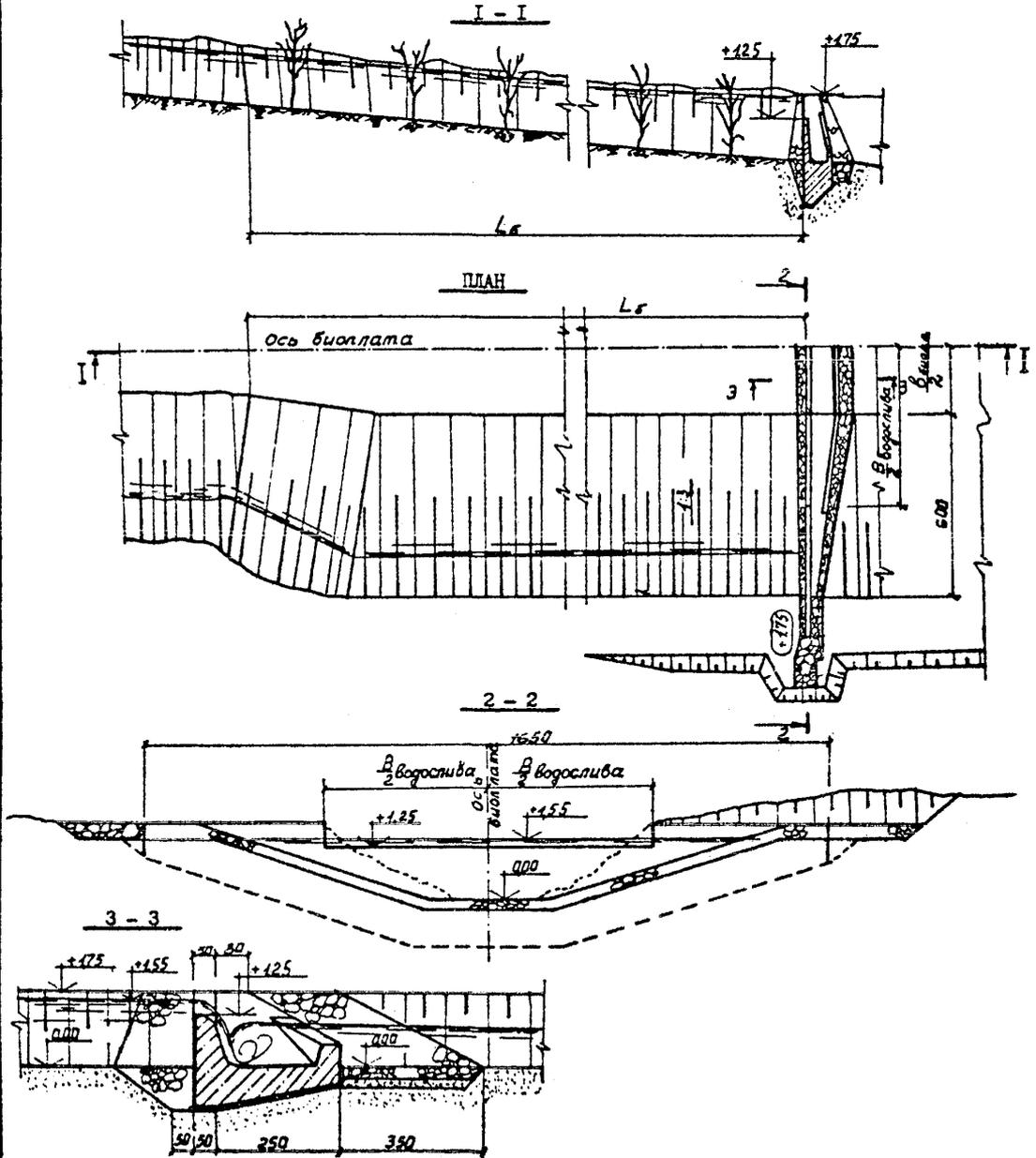
УСТЬЕВЫЕ БИОПЛАТА НА РАСХОД ВОДЫ ДО 5 м<sup>3</sup>/сТИПОВЫЕ ПРОЕКТНЫЕ
