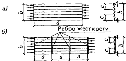
Черт. 12. Расчетная схема сжатого гофрированного листа
