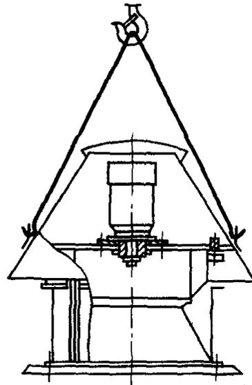
Рис. 17. Строповка вентилятора
