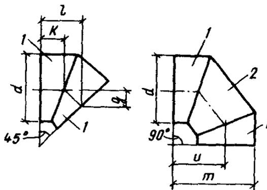
Рис. 2. Отводы круглого сечения
