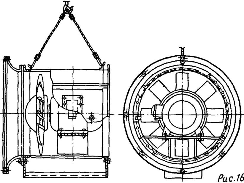
Рис. 16. Строповка осевого вентилятора
