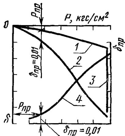
1, 2—относительное сжатие  $\delta$  грунта с природной влажностью и в водонасыщенном состоянии в зависимости от давления; 3—дополнительное относительное сжатие грунта в результате замачивания (относительная просадочность) при заданном давлении; 4—зависимость относительной просадочности  $\delta_{\text{пр}}$  от давления;  $P_{\text{пр}}$  — начальное просадочное давление
