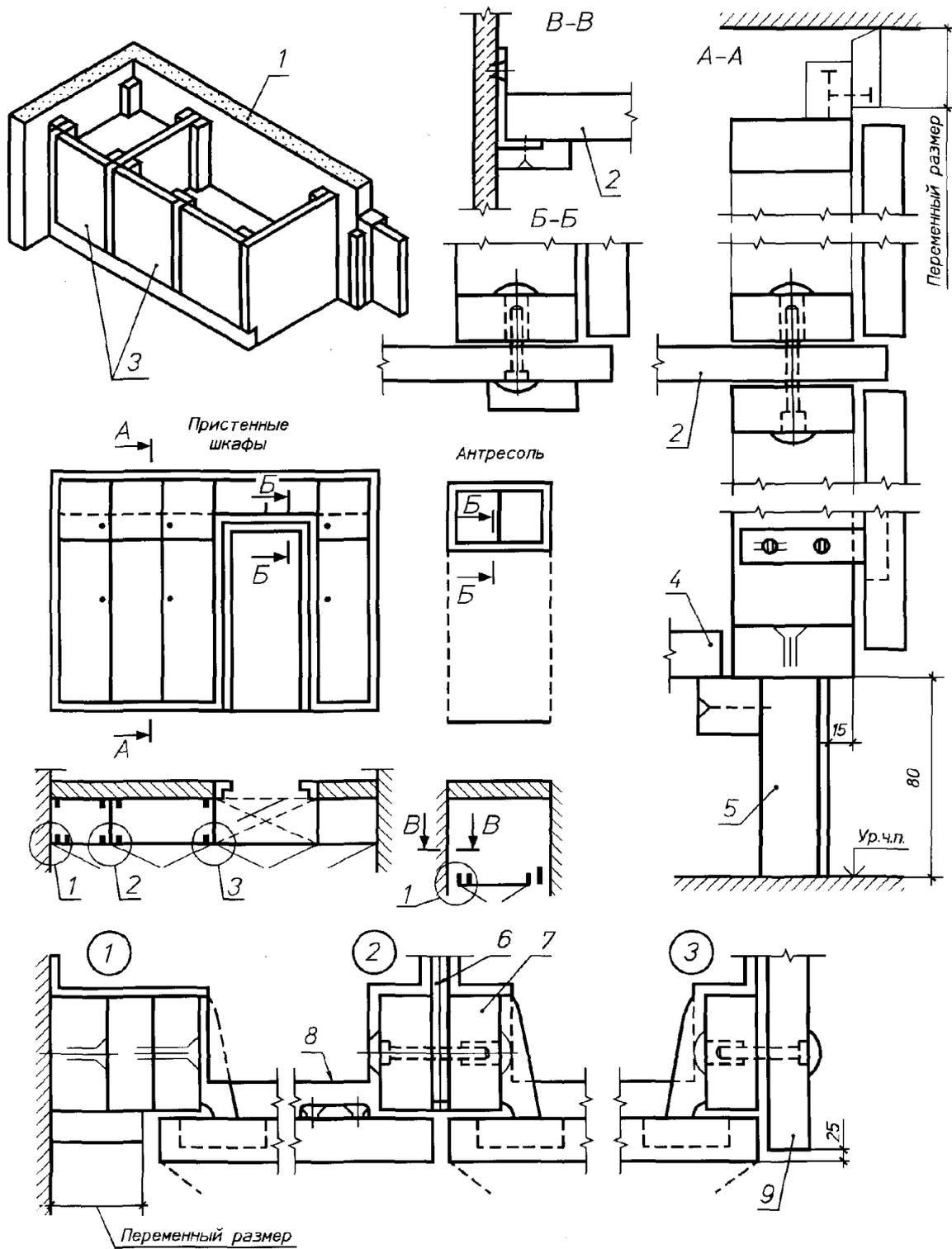
1 — стена; 2 — полка антресольная; 3 — дверки шкафа; 4 — полка переставная; 5 — цоколь; 6 — стенка промежуточная; 7 — каркас блока дверок; 8 — полка; 9 — боковая стенка
