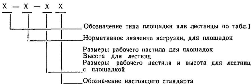
Пример условного обозначения площадок, навешиваемых на лестницы, из алюминиевых сплавов с нормативным значением нагрузки 1000 Н и размерами рабочего настила  $0,6 \times 0,6$  м:
