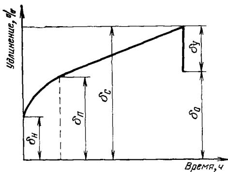
$\delta_H$ —удлинение при нагружении;  $\delta_\pi$ —полное (упругое + остаточное удлинение на криволинейном участке);  $\delta_c$ —суммарное (упругое + остаточное) удлинение за время испытания;  $\delta_y$ —упругое удлинение;  $\delta_o$ —остаточное удлинение
