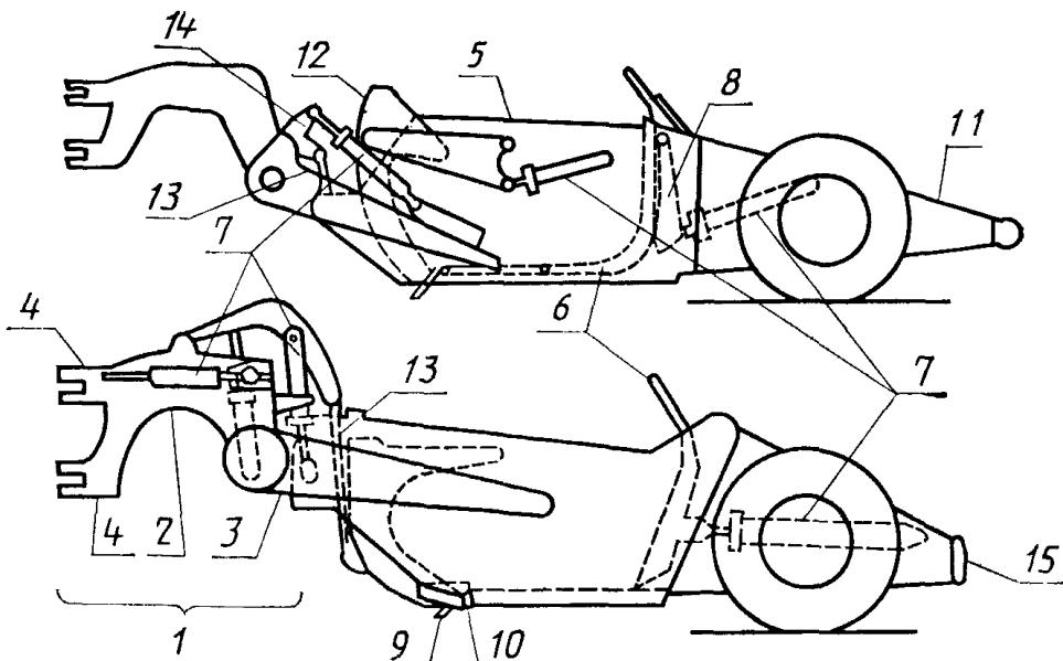
1 — тяговая рама; 2 — хобот; 3 — упряжная тяга; 4 — кронштейн поворотного шкворня; 5 — ковш; 6 — задняя стенка ковша; 7 — гидроцилиндр; 8 — рычаг задней стенки; 9 — режущий нож; 10 — подрезной нож; 11 — буферная рама; 12 — заслонка; 13 — тяга заслонки или ковша; 14 — рычаг заслонки или ковша; 15 — буфер
