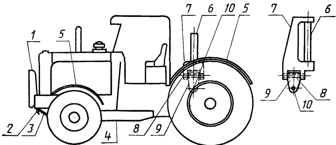
1 — бампер; 2 — буксирный крюк; 3 — нижний защитный лист картера; 4 — основная рама; 5 — крыло; 6 — шкворень сцепного устройства; 7 — сцепное устройство; 8 — палец шарнира поперечного качания; 9 — серьга сцепного устройства; 10 — палец шарнира продольного качания
