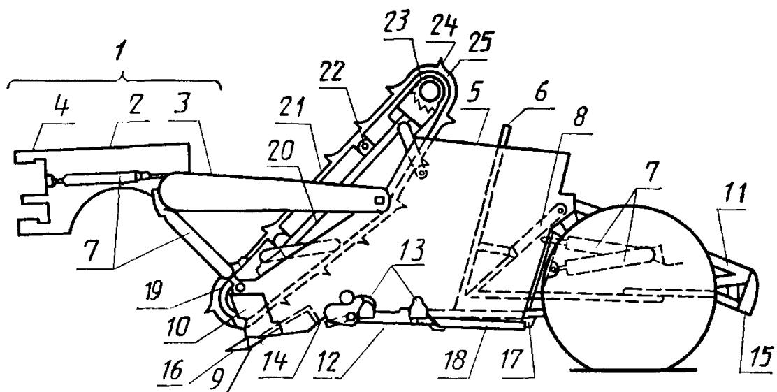
1 — тяговая рама; 2 — хобот; 3 — упряжная тяга; 4 — кронштейн поворотного шкворня; 5 — ковш; 6 — задняя стенка ковша; 7 — гидроцилиндр; 8 — рычаг задней стенки; 9 — режущий нож; 10 — подрезной нож; 11 — буферная рама; 12 — откатное днище; 13 — ролики днища; 14 — козырек; 15 — буфер; 16 — зуб; 17 — рычаг днища ковша; 18 — тяга днища ковша; 19 — нижняя звездочка; 20 — рама элеватора; 21 — цепь; 22 — промежуточный ролик; 23 — приводная звездочка; 24 — скребок; 25 — привод элеватора
