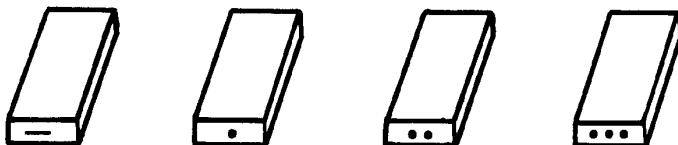
Маркировка на одном из торцов для пиломатериалов и заготовок толщиной менее 25 мм
