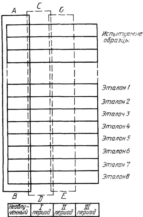
AB — пластиинка, перекрывающая образцы и эталоны при закреплении их на кассетах; CD — вторая пластиинка; GE — третья пластиинка
