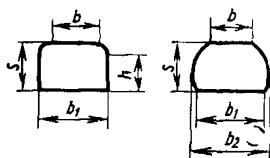
*b* — ширина верхней пласти; *b*<sub>1</sub> — ширина нижней пласти, *b*<sub>2</sub> — ширина шпалы по непропитанным сторонам; *s* — толщина шпалы; *h* — высота пропиленной части боковой стороны
