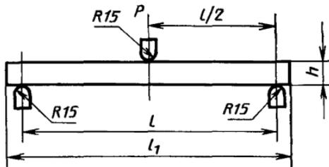
1.4.2. Образец нагружают равномерно с постоянной скоростью нагружения. Скорость должна быть такой, чтобы образец разрушился через  $(60 \pm 30)$  с после начала нагружения. Максимальную нагрузку  $P_{\max}$  измеряют с погрешностью не более 1%.
