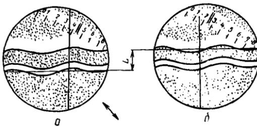
Примечание. Если световая полоса искривлена, то горизонтальную визирную нить окулярного микрометра устанавливают на глаз так, чтобы площади, заключенные между ней и линией, очерчивающей край световой полосы, были примерно равны.
