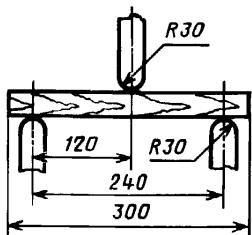
Испытание продолжают до разрушения образца, определяя максимальное показание стрелки силоизмерителя. Максимальную нагрузку  $P_{\max}$  определяют с погрешностью не более 1 %.
