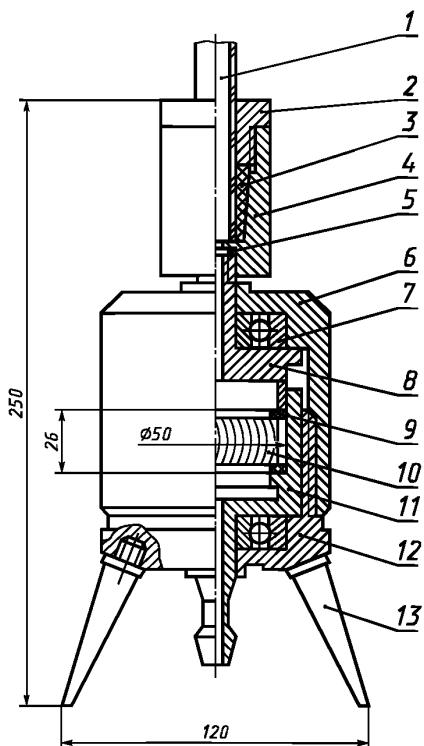
Прибор (см. чертеж), обеспечивающий измерение проницаемости воды с погрешностью не более  $0,2 \text{ см}^3$  при давлении  $(1 \cdot 10^4 \pm 3 \cdot 10^2) \text{ Па}$ .
