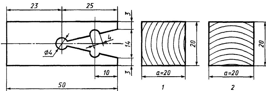
1 — при раскалывании по плоскости радиального разреза;
