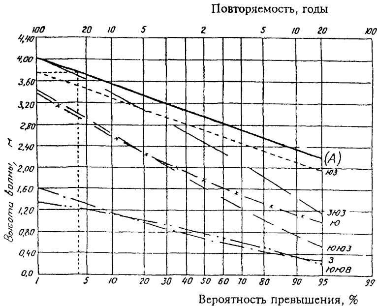
Рисунок Б.1 - Кривые распределения вероятностей превышения годовых максимальных высот волн
