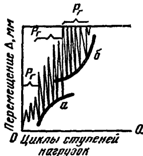
Рис. 17. График циклических перемещений свай
