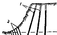
Рис. 5.9. Комбинирование скважинных и шпуровых зарядов:
