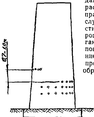
Рис. 5.13. Расположение шпуров при обрушении дымовой трубы
