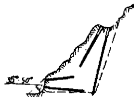
Рис. 5.7. Комбинированное расположение скважин на косогорах с уклоном 35—50°
