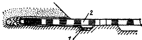
Черт. 107. Горизонтальная самоизливающаяся скважина на откосе
