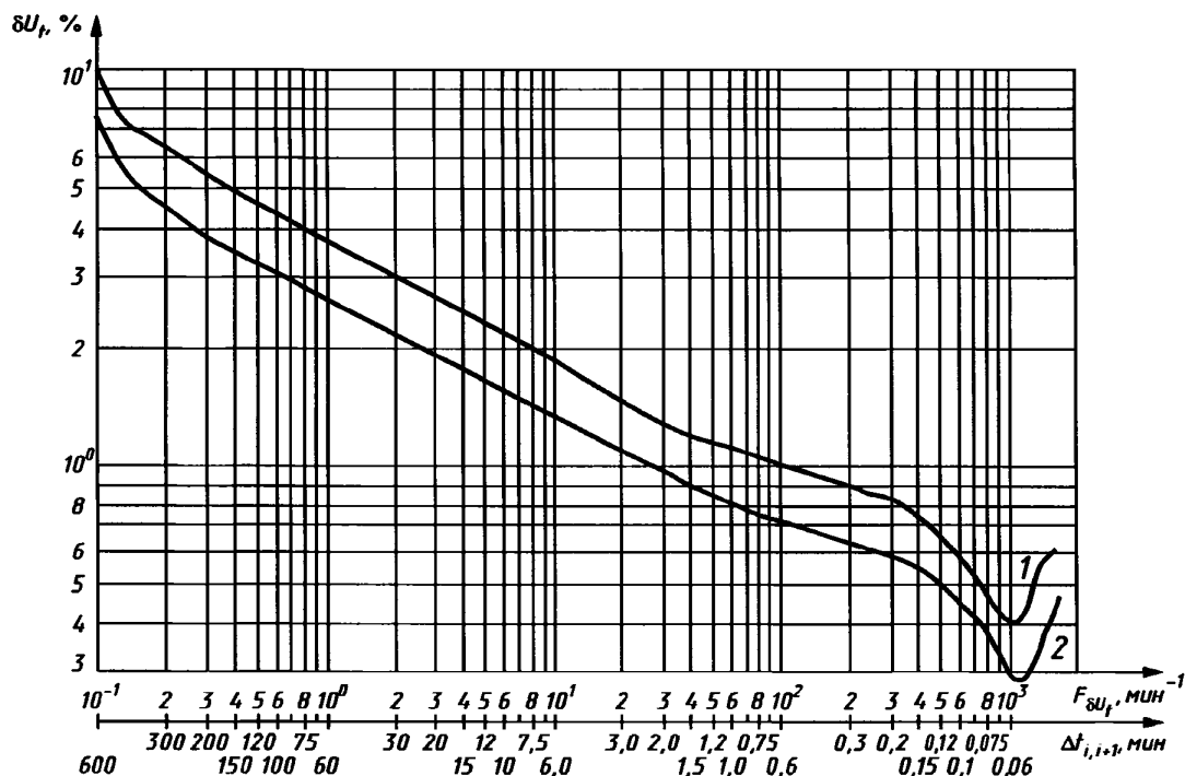
Рисунок 1 — Предельно допускаемые размахи изменений напряжения в зависимости от частоты повторения изменений напряжения за минуту для колебаний напряжения, имеющих форму меандра
