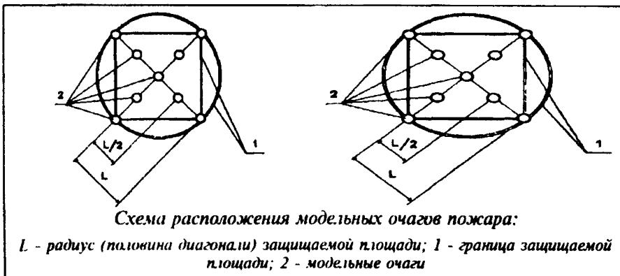
Схема расположения модельных очагов пожара:
