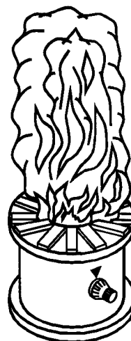
Рисунок В.2 — Расположение буквых брусков при проведении испытаний на чувствительность к тестовому очагу пожара ТП-2
