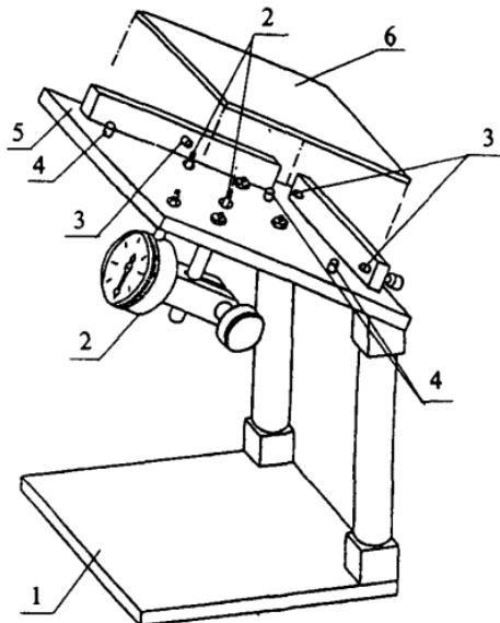
**1 — основание прибора; 2 — индикатор; 3 — ограничитель установки граней плитки;
