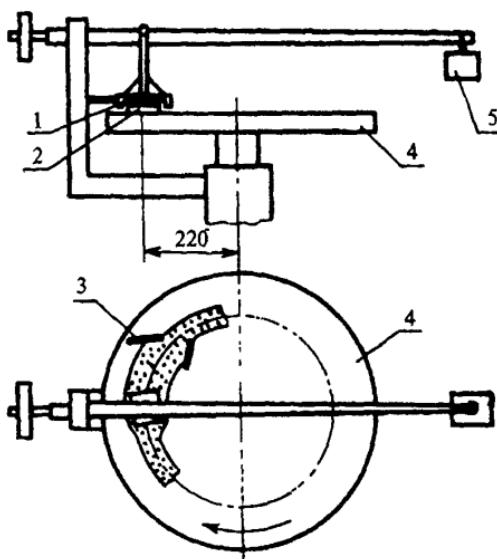
1 — держатель; 2 — образец; 3 — резиновый скребок; 4 — шлифовальный диск; 5 — нагруженное устройство
