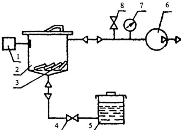
1 — сигнализатор уровня воды; 2 — вакуумная камера; 3 — образцы; 4 — электромагнитный клапан подачи и слива воды; 5 — бак с водой; 6 — вакуумный насос; 7 — вакуумметр; 8 — электромагнитный клапан сообщения камеры с атмосферой
