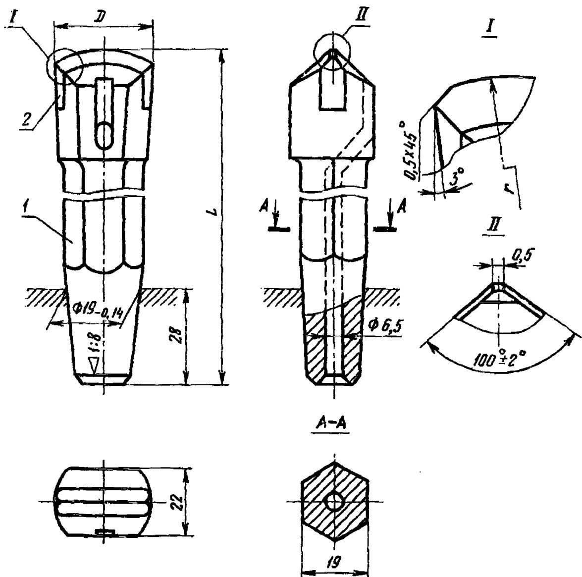
1 — корпус бура; 2 — пластина твердосплавная по технической документации, утвержденной в установленном порядке.
