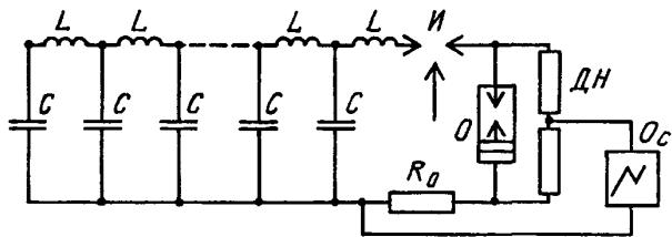
$C, L$  — емкости и индуктивности генератора импульсов тока большей длительности соответственно;  $I$  — управляемый искровой промежуток;  $R_o$  — шунт для измерения тока;  $O$  — испытуемый образец или разрядное сопротивление;  $DH$  — делитель напряжения;  $Os$  — осциллограф
