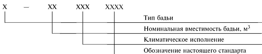
Пример условного обозначения бадьи проходческой для механизированной разгрузки, номинальной вместимостью 4,5 м<sup>3</sup>, для климатического исполнения У:
