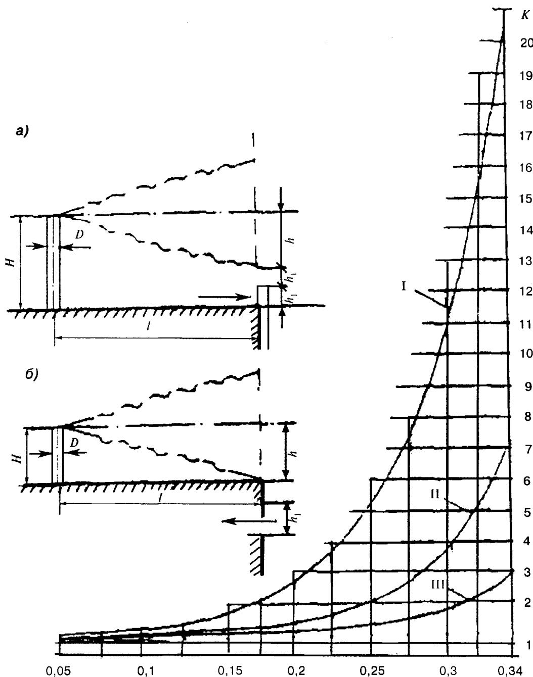
*a* — расположение источника над зоной всасывания наружного воздуха приемным устройством (высота трубы источника  $H = 2h_1 + h$ ); *б* — то же, над кровлей здания (высота трубы источника  $H = h$ );
